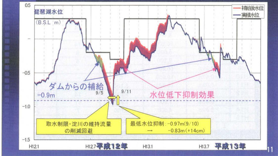
※近年の渇水時の実績から、取水制限開始水位を-90cmと仮定しています。
