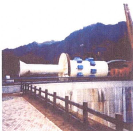
深層曝気設備(設置前)
