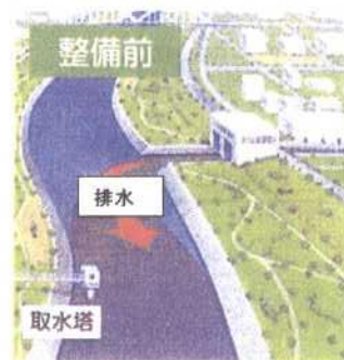
下水処理場で処理した排水を直接 河川へ放流
