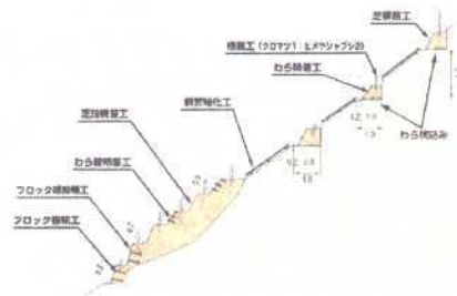
瀬田川（田上山）の積苗工
