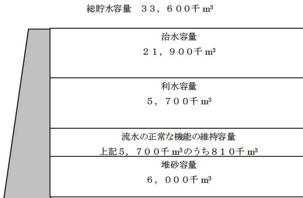
図1 従来計画の大戸川ダムの容量配分
