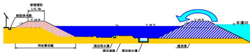
横断面図：木津川下流遊水地（第1池） 58.8k 付近
