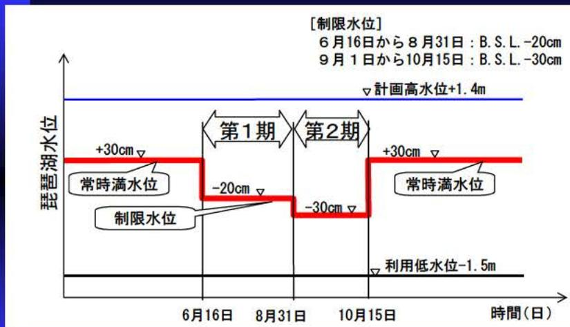
琵琶湖水位が、洪水期間にあつては制限水位を、非洪水期間にあつては常時満水位を超えているとき又は超えることが予測されるときは、洗堰からの放流により、琵琶湖の水位をこれらの水位に低下させ、又は琵琶湖の水位の上昇を抑制しなければならない。(瀬田川洗堰操作規則より抜粋) 6
