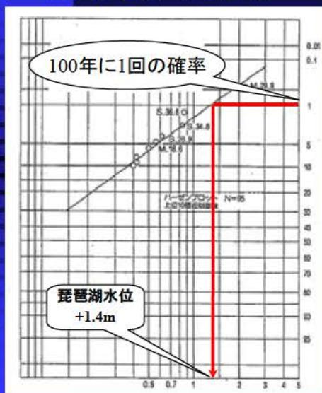
明治7年～昭和43年までに起きた洪水時流入量から水位上昇量を計算した結果を統計処理し、100年間に1回超過すると予想される琵琶湖の最高到達水位を計画高水位として定義されています。
