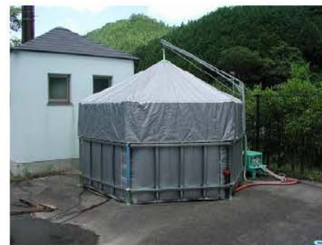
堆肥製造装置(チップ材発酵中)
