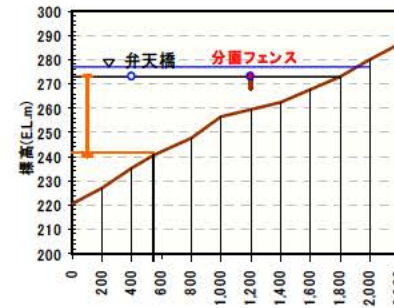
青蓮寺ダム縦断面図（青蓮寺川） 最深部河床高(H16)
