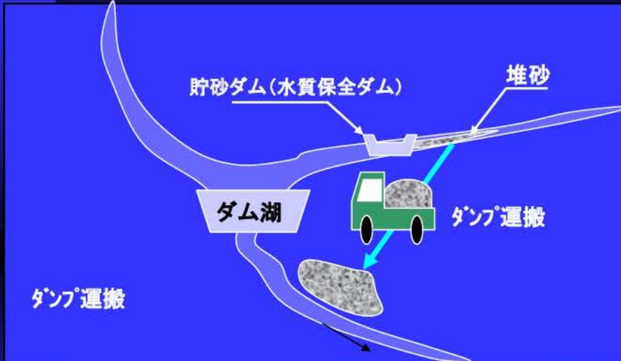
土砂を貯砂ダム(水質保全ダム)によってダム湖に流れ込む前に貯めた後取り除き、ダンプで下流へ運ぶ。
