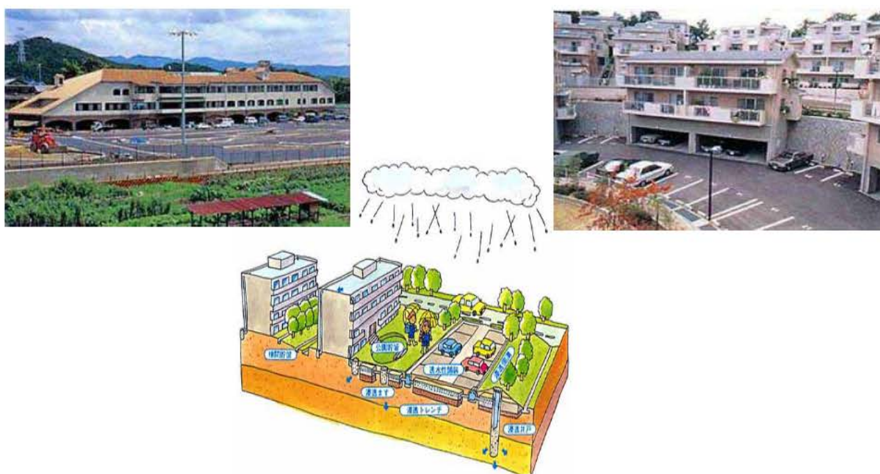
図 4.3.1-3 洪水氾濫被害軽減のための地域整備方策例（ピロティ構造）
