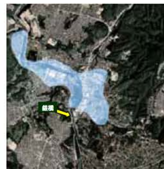
写真 4. 3. 3-4 猪名川銀橋狭窄部上流の浸水被害状況
