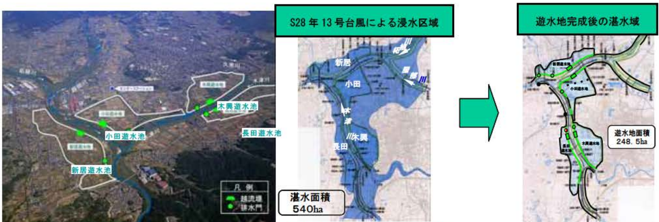
図4.3.3-2 上野地区の浸水被害軽減を図る上野遊水池
