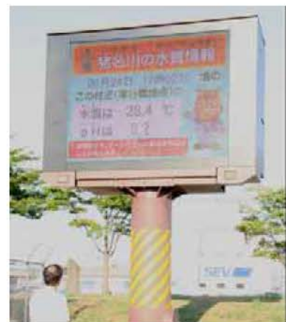
写真 4.3.1-1 河川情報表示板
