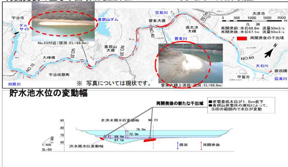
図-24 再開発後の天ヶ瀬ダム貯水池の主な干出域
