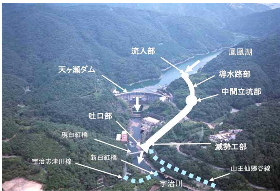
写真-1 トンネル式放流施設概要図(施設配置図)
