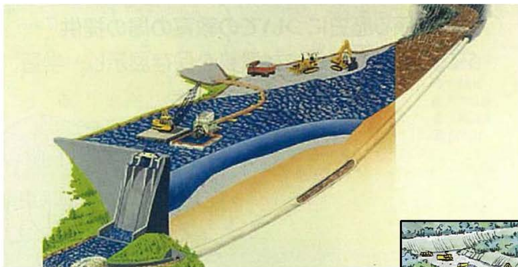
図 5.1.3 浚渫による堆砂除去
