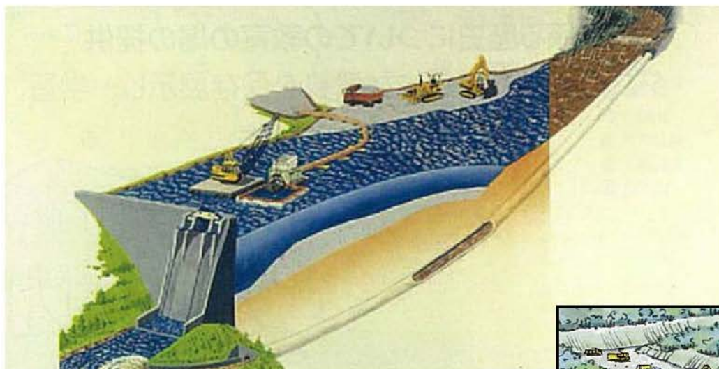
図 5.1.3 浚渫による堆砂除去
