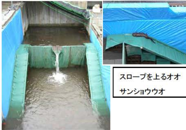
図 7.3.4 オオサンショウウオ道（スロープ式） の試験状況（C区画）
