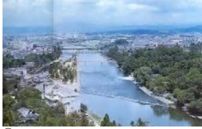
② 1989年の塔の島と橋島（宇治市）。島掘削後、護岸が直線化され砂洲が消滅。河床低下。河原が現れることはない。
