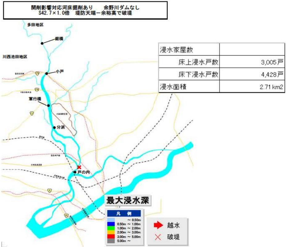
図-15(1) 昭和42年7月洪水浸水想定図（余野川ダムなし）
