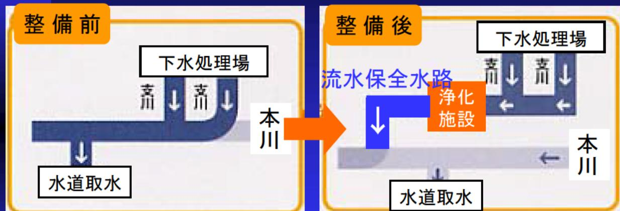
下水処理場で処理した排水を直接河川へ放流
