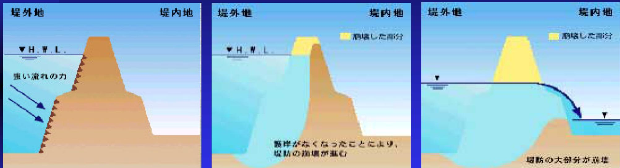
■ 洪水の流れが堤防にあたり堤防が破壊されます。
