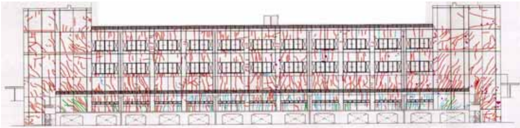
大川側外壁のひび割れ
