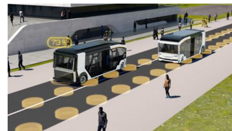
大阪・関西万博で実装が予定される走行中給電システム
