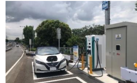
実験中の路上EV充電機器 (横浜市)
