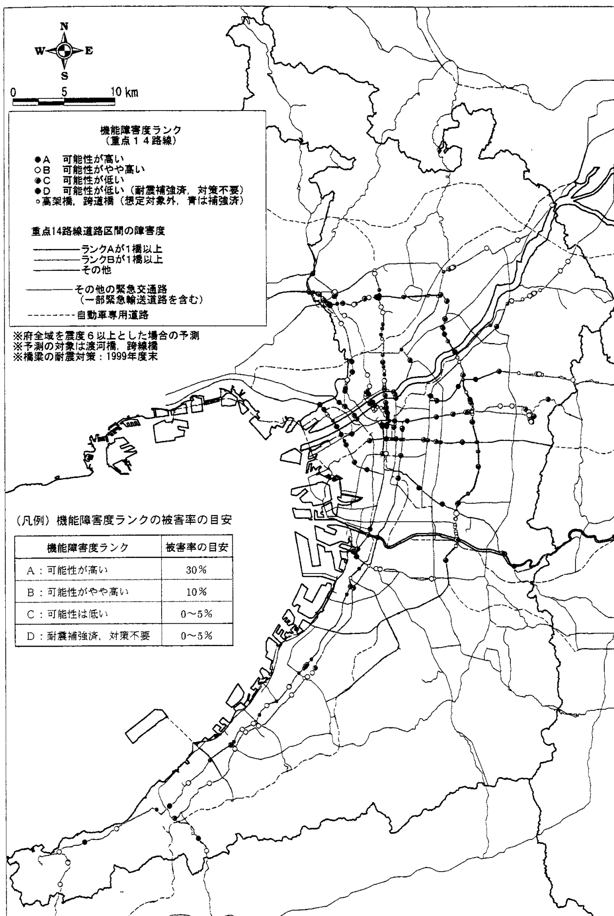
図-5 重点14路線の震度6以上に対する橋梁の機能障害度予測〔1999年度末:耐震補強進行中〕
