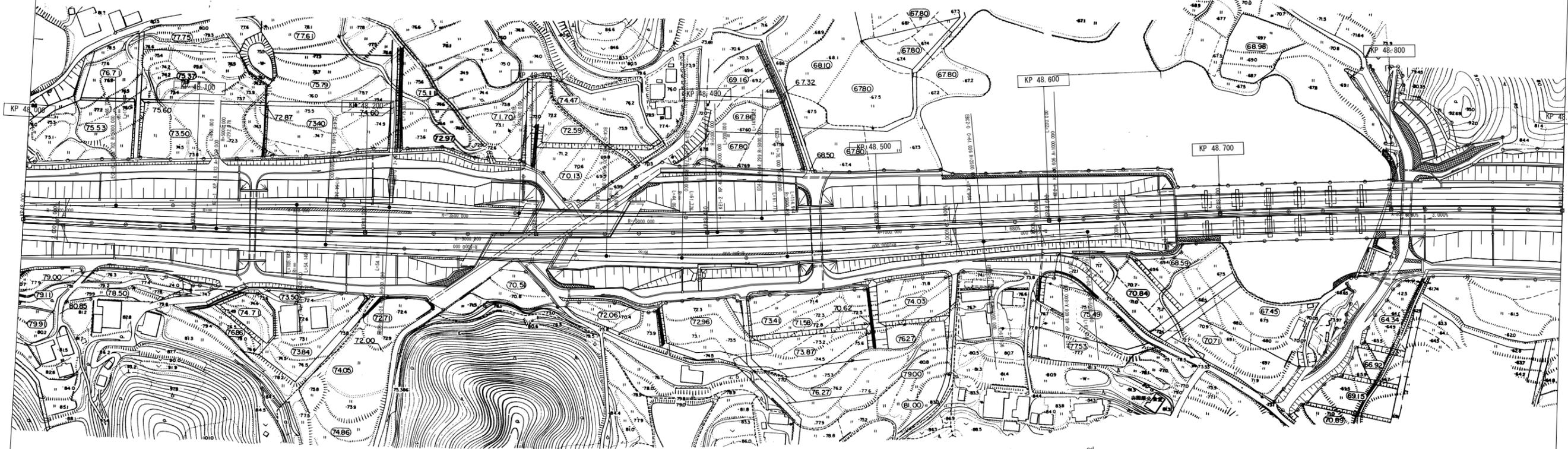
テーパー長 L=75.00 加速車線 L=130.00 二次加速車線 L=30.00 停留車線 L=20.00 二次減速車線 L=40.00 減速車線 L=100.00 テーパー長 L=50.00
