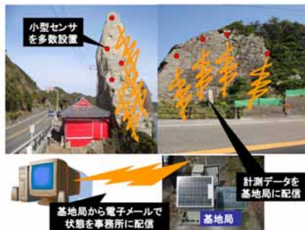
図-1 センサネットワークシステムの概念
