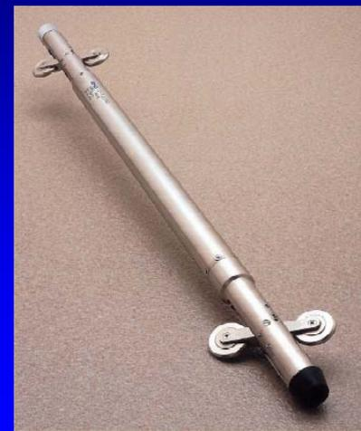
孔内傾斜計 プローブ
