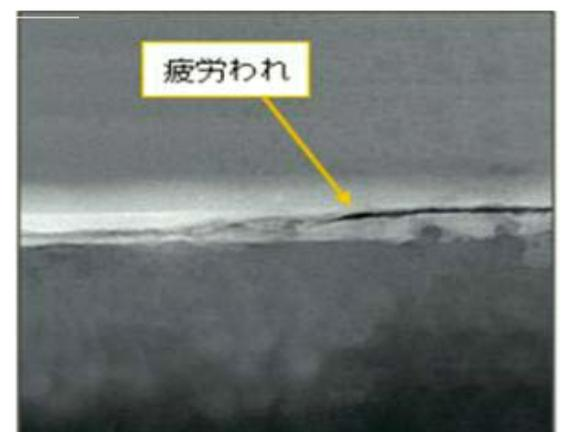
写真 6 溶接部のき裂の画像例
