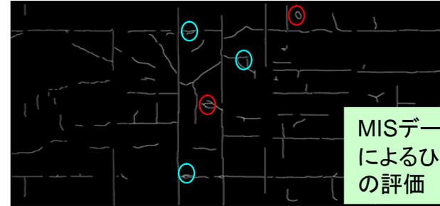
MISデータ(展開図)によるひび割れ閉合の評価
