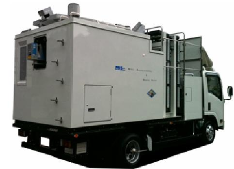
走行型計測車両（MIMM）はMISとMMSの機能を1台の車両に搭載したもので、1回の走行で、画像とレーザによる3D計測が同時に行えるものである。
