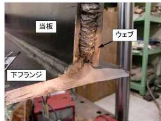
縦桁試験体の疲労破断面
