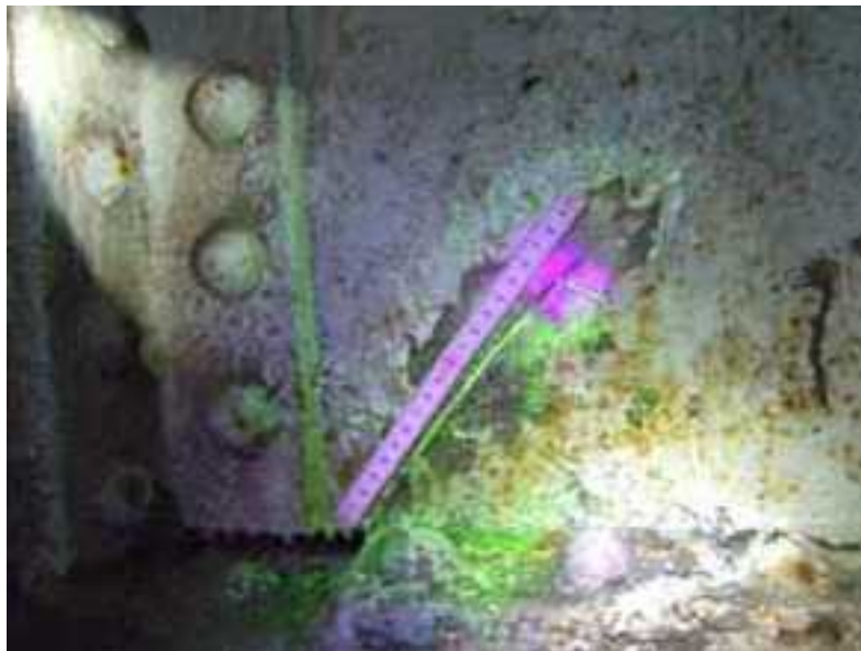
磁粉探傷(MT)による調査
