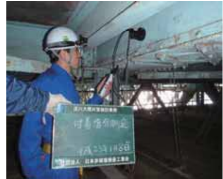
写真2 付着塩分測定状況
