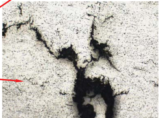
図26 残置したきずのマクロ・マイクロ組織試験
