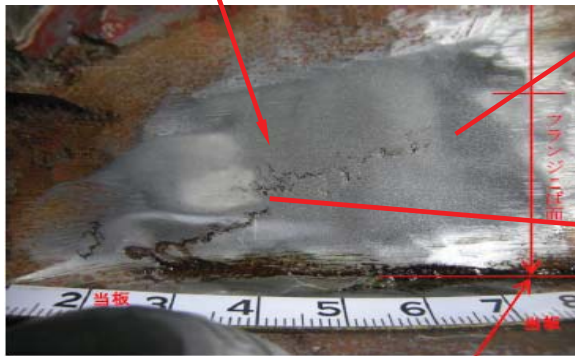
図26 残置したきずのマクロ・マイクロ組織試験
