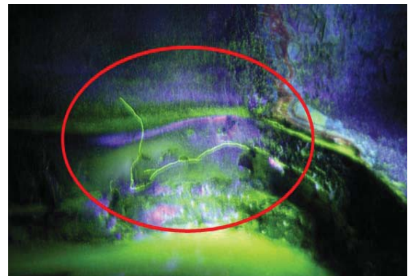
図2-3 削除前の表面き裂磁粉模様
