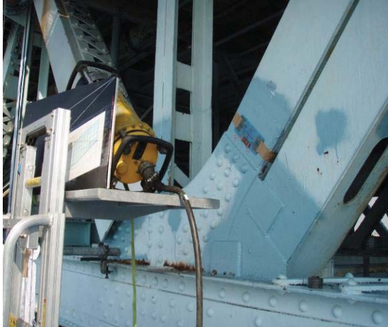
図6 X線透過試験実施状況
