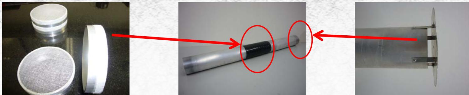
外径100mm, 内径96mm, 厚さ20mmのリング10個を連結
