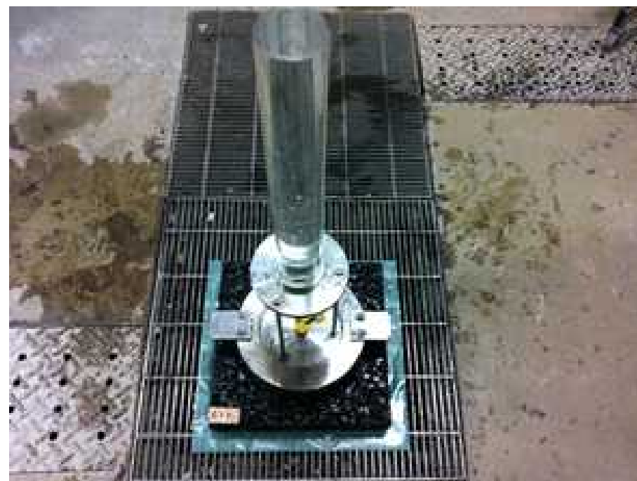
現場透水試験
