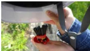
落ち葉の堆積状態を光ファイバーの端部で目視確認できる。これをパトロールの際にアクセスしやすい場所に設置すると作業が効率化
