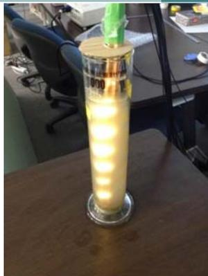
マスの中に装着予定の装置模型を使った模擬実験。泥水をメスシリンダーに入れ、土粒子が沈降してゆくプロセスをLS<sup>3</sup>/digital方式で計測。縦にセンシングポイントが8か所（8番が一番下）設けられており、それぞれの個所において浮遊する土粒子が多ければ、それらが光を反射する要因となり、結果的に受光強度が高くなる。また、それらの沈降が進むと受光強度が落ちてゆくプロセスを捉えることに成功。この様式で現場のマスにサイズを合わせた装置を製作予定。
