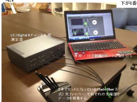
光ファイバーによる測定用に開発されたLS³/digital測定器。この機種では2本の光ファイバー(1=光を送る、2=光を計る)をセットで実施する計測ユニットを同時に8セット接続することが可能
