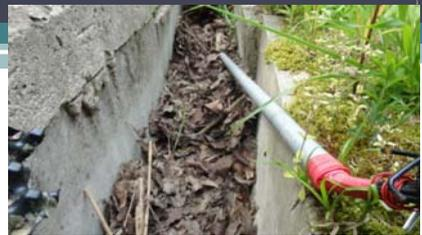
観測ポイントを複数取り付けけた装置（この場合は円柱）を落ち葉などが堆積すると思われる箇所に設置し、その状態を監視できる。棒に設置されている光ファイバーは上を向くように置き、そこに太陽光が入る状態にして用いる。電気を使わないエコな方法。
