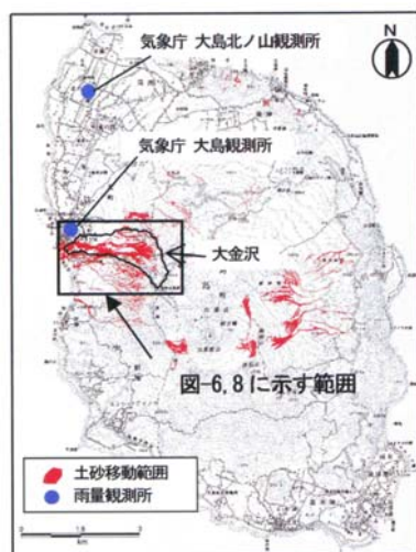
雨量観測所の位置および台風26号による土砂移動範囲
