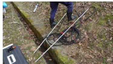
長さ2mの測定棒を2本用意し、それぞれ上段法面、下段法面に設置。測定棒には20cm間隔で光ファイバーのセンサユニットが8箇所（一番下が1番で、上が8番）ずつ装着されている。
