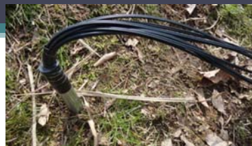
長さ2mの測定棒を地盤に埋設した様子。
