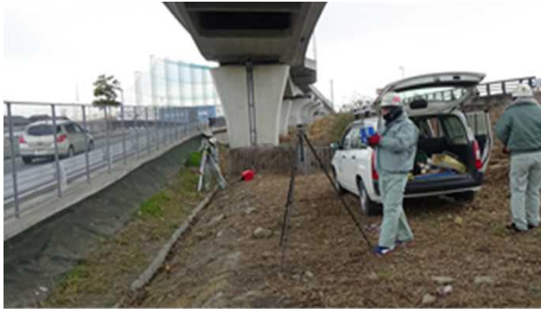
ひび割れ計測機による橋梁計測
