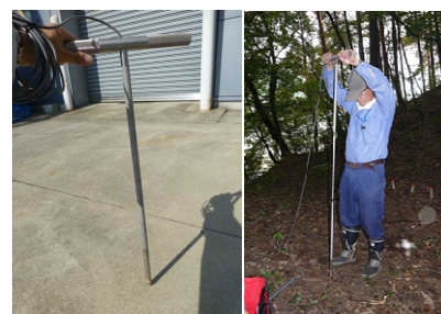
写真1 盛土内部の宙水計測の様子
