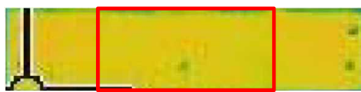
②15:33 散水冷却後 気化熱により温度低下
