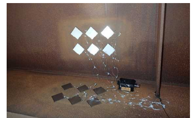
図-1 ワッペン試験片設置状況
