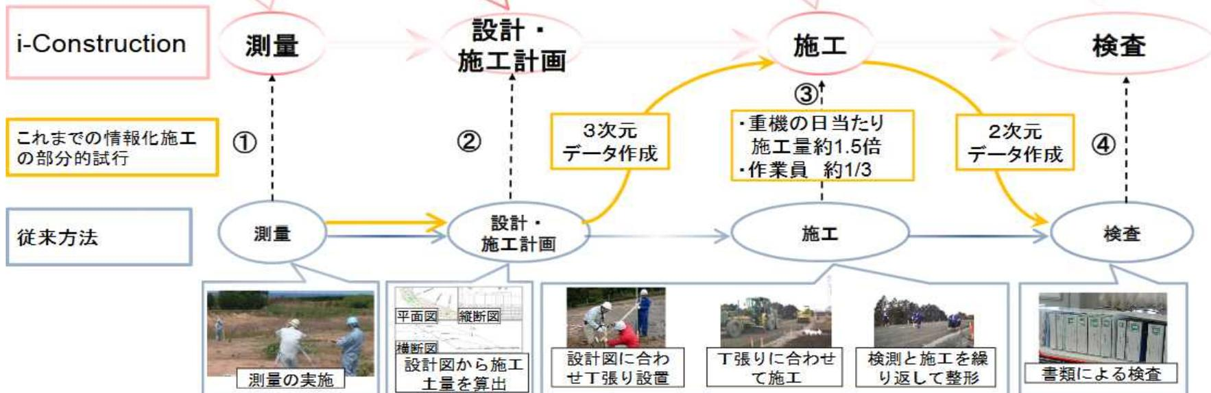
建設現場の施工フェーズにおける生産性の向上を目的に、レーザスキャナやUAVを用いて計測した3次元情報を積極的に活用する「i-Construction」の取り組みが推進
