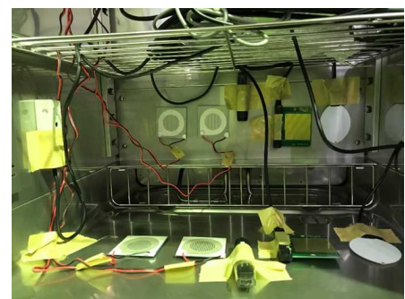
図-1 恒温恒湿試験機でのセンサ設置状況
