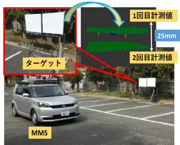
図-7 MMS による法面変状検出技術検証結果
