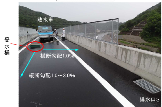
孝子ランプ橋における排水実験の概要
