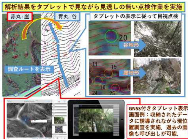
図-3 タブレット型 PC を用いた現位置調査手法の例
