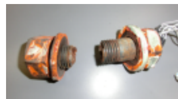
図1 遅れ破壊が生じていたF11Tの高力ボルト (塗装の付着により脱落しているボルトがないものの、亀裂が内在しており容易に折損するボルトを発見)
