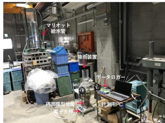
図4 円筒カラムを用いた降雨浸透試験装置
