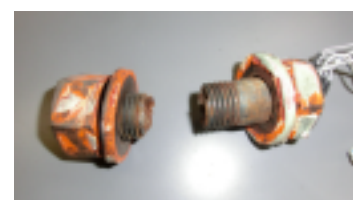
図1 遅れ破壊が生じていたF11Tの高力ボルト (塗装の付着により脱落しているボルトがないものの、亀裂が内在しており容易に折損するボルトを発見)
