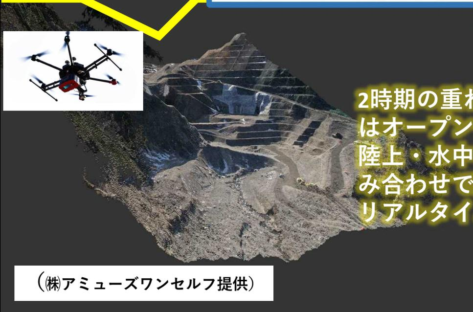
2時期の重ね合わせソフトはオープン化されている：陸上・水中ドローンとの組み合わせで迅速・簡便・リアルタイムに斜面を調査
