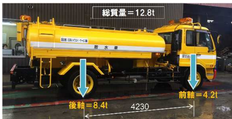
走行試験載荷車 (散水車 ≒ 13t)
