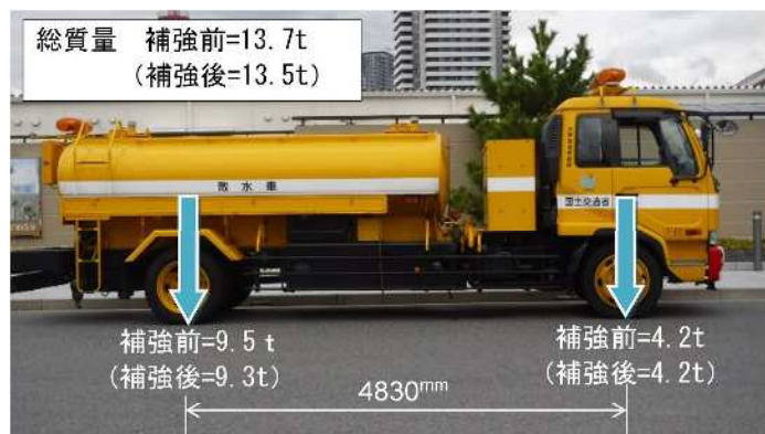
走行試験 試験車 (散水車 ≒ 13.5t)
