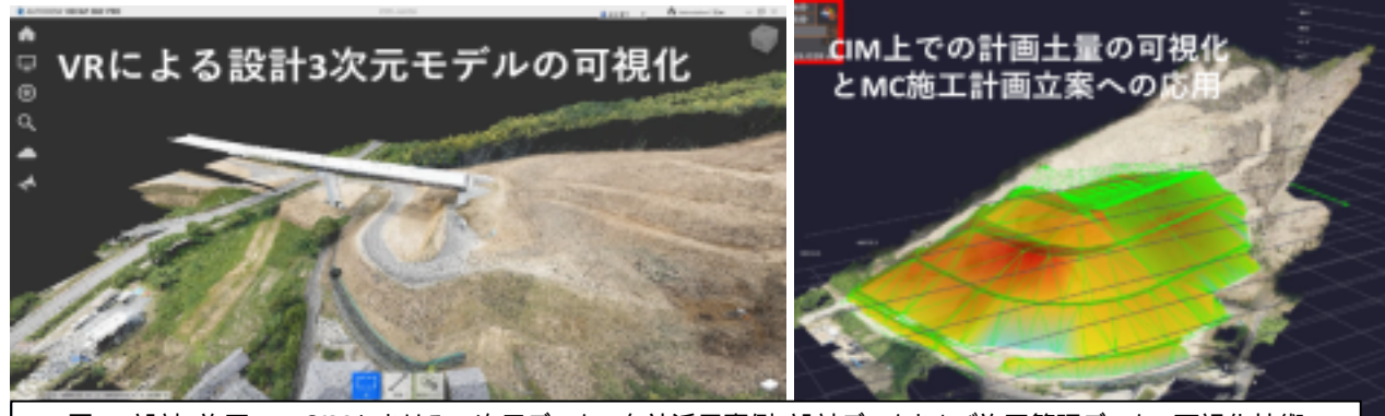
図3 設計・施工での CIM における 3 次元データの有効活用事例:設計データおよび施工管理データの可視化技術
