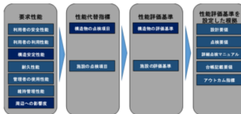
トンネル性能規定と点検評価、性能規定文書の関係：野村らの研究成果による
