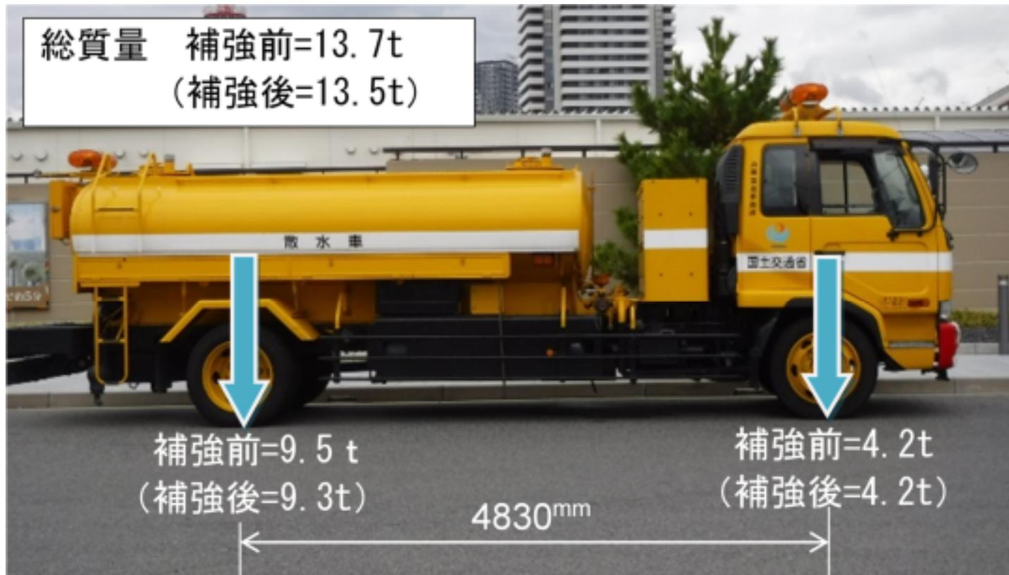
走行試験(散水車) 試験車両諸元
